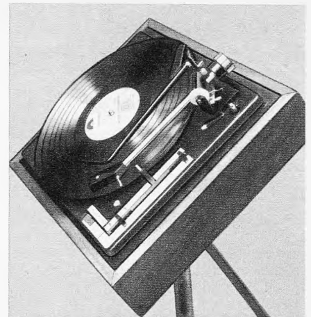
Bild 4. In dieser schiefen Lage wurde der Tonarm des Plattenspielers UA 70 von BSR noch sicher in den Rillen der Schallplatte geführt
