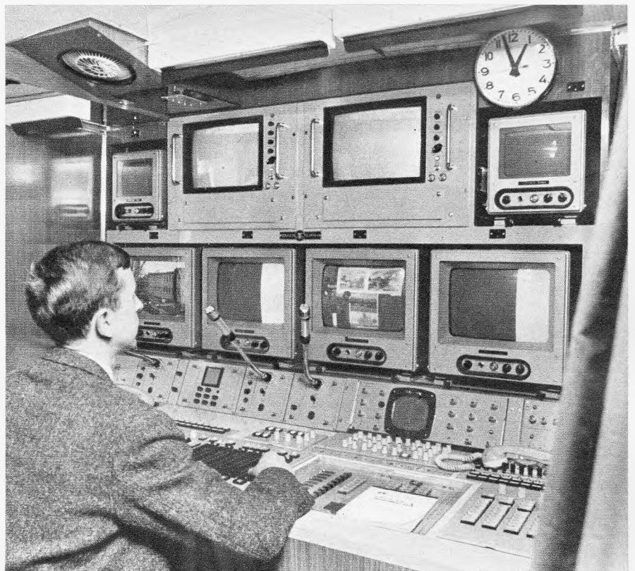
Bild 1. Bildregie mit Farb- und Schwarzweiß-Monitoren im neuen, 11,5 m langen und 20 t schweren Farbfernseh-Übertragungswagen des Norddeutschen Rundfunks. Er hat drei getrennte Räume für Bildregie, Bildtechnik und Tonregie/Tontechnik. Die vier mitgeführten Plumbikon-Farbfernsehkameras können bis zu 600 m entfernt vom Wagen arbeiten und brauchen nur etwa 60 % mehr Licht als Schwarzweißkameras, d. h. 1500 Lux. Über den Übertragungswagen und weitere Einzelheiten der Farbfernseh-Vorbereitungen des NDR wird ein Beitrag in Heft 11 berichten
