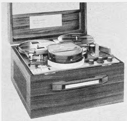
Bildaufzeichnungsgerät MF 300 von Graetz mit zwei rotierenden Magnetköpfen und a-Umschlingung der Kopftrommel. Bandgeschwindigkeit 17,8 cm/s
